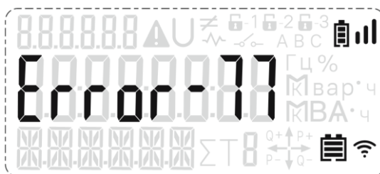
Рисунок 8 – Ошибка «Отсутствует связь с прибором учета»
