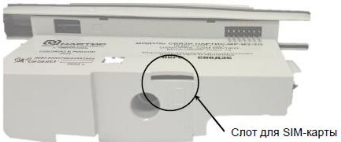
Рисунок И.2 – Расположение слота SIM-карты в корпусе модуля связи НАРТИС-МР-М2.1
