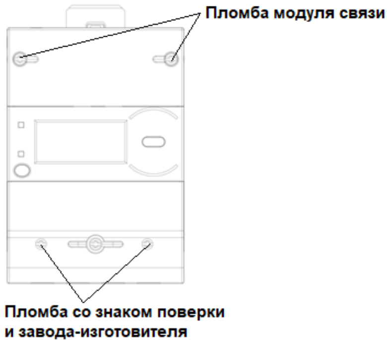
Рисунок 10 – Схема пломбирования счетчика в корпусе типа W113
