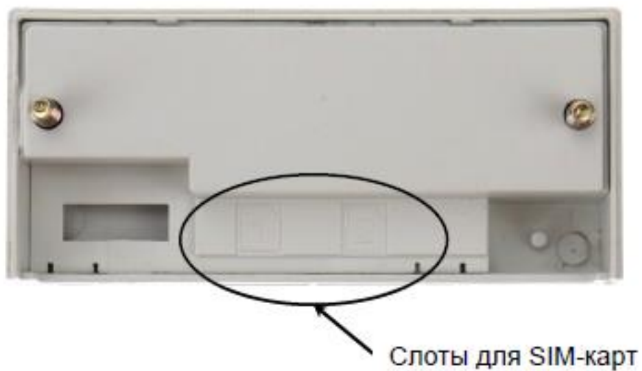
Рисунок И.3 – Расположение слотов SIM-карт в корпусе модуля связи НАРТИС-МР-М3.1
