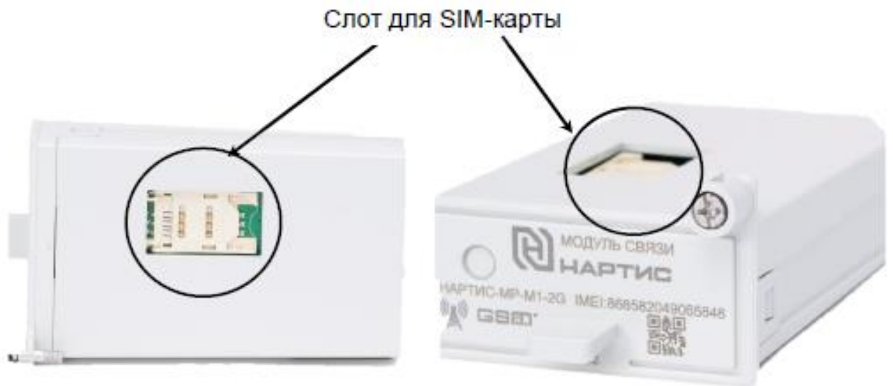
Рисунок И.1 – Расположение слота SIM-карты в корпусе модуля связи НАРТИС-МР-М1
