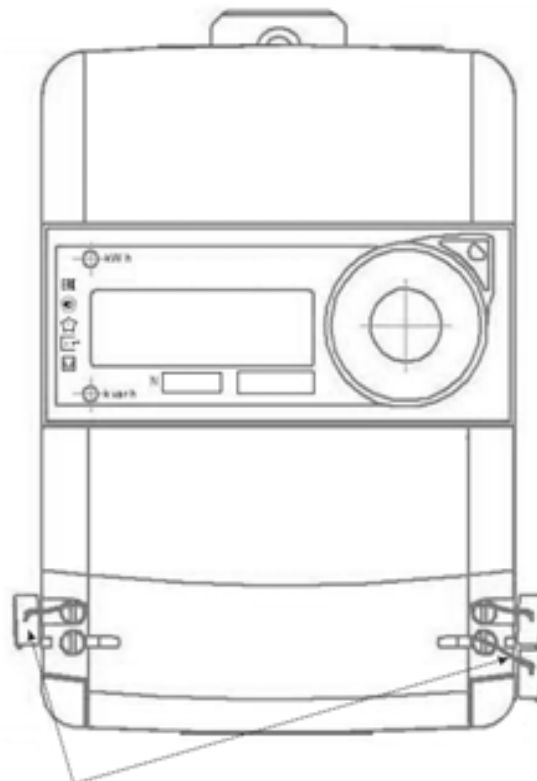
Рисунок 8 – Схема пломбирования счетчика в корпусе типа W111
