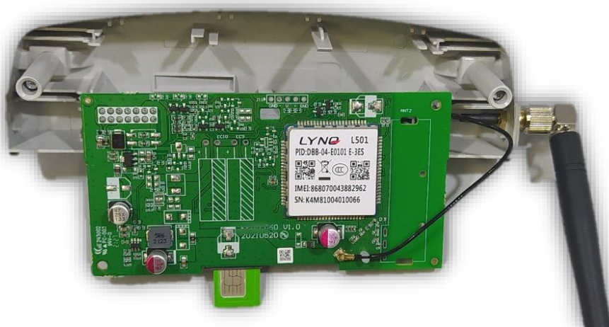
Рисунок 2 – Установка SIM-карты в GSM-модуль счетчика НАРТИС-И300 W131
