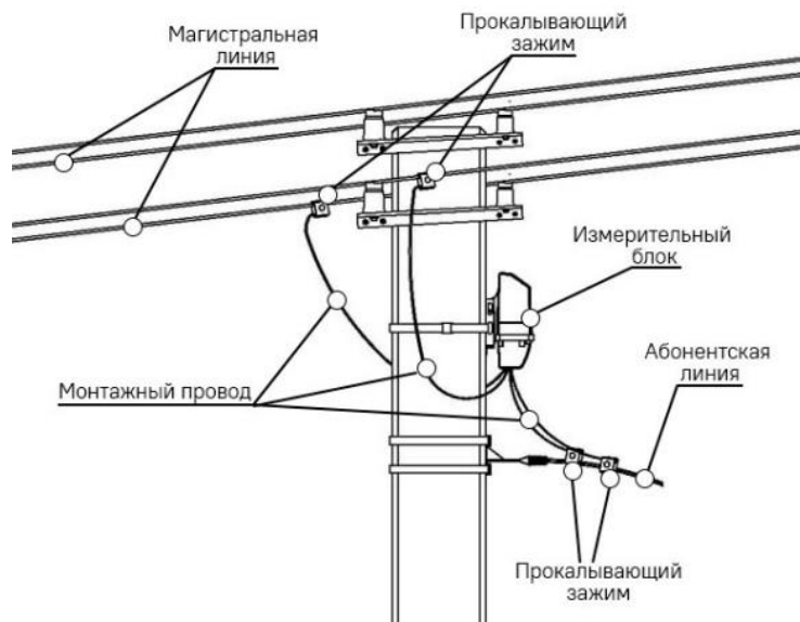
Рисунок 10 – Подключение блока измерительного счетчика НАРТИС-И100-SP1 на опоре воздушной линии электропередач
