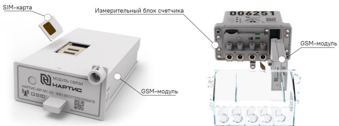
Рисунок 3 – Установка SIM-карты в GSM-модуль блока измерительного счетчика НАРТИС-И100-SP1
