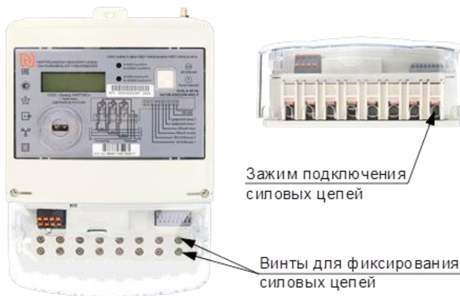
Рисунок Е.1 – Расположение зажимов и винтов для подключения силовых цепей счетчика в корпусе типа W131
