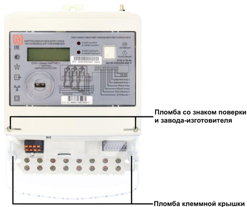
Рисунок И.2 – Схема пломбирования счетчика в корпусе типа W132
