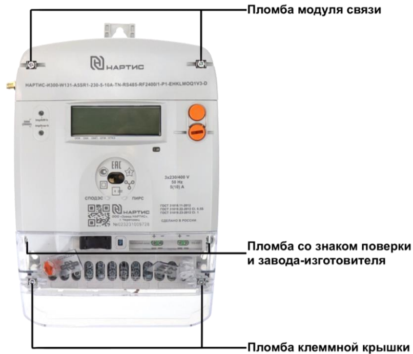
Рисунок И.1 – Схема пломбирования счетчика в корпусе типа W131
