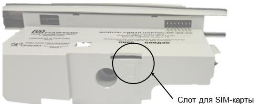
Рисунок Д.2 – Расположение слота SIM-карты в корпусе модуля связи НАРТИС-МР-M2.3
