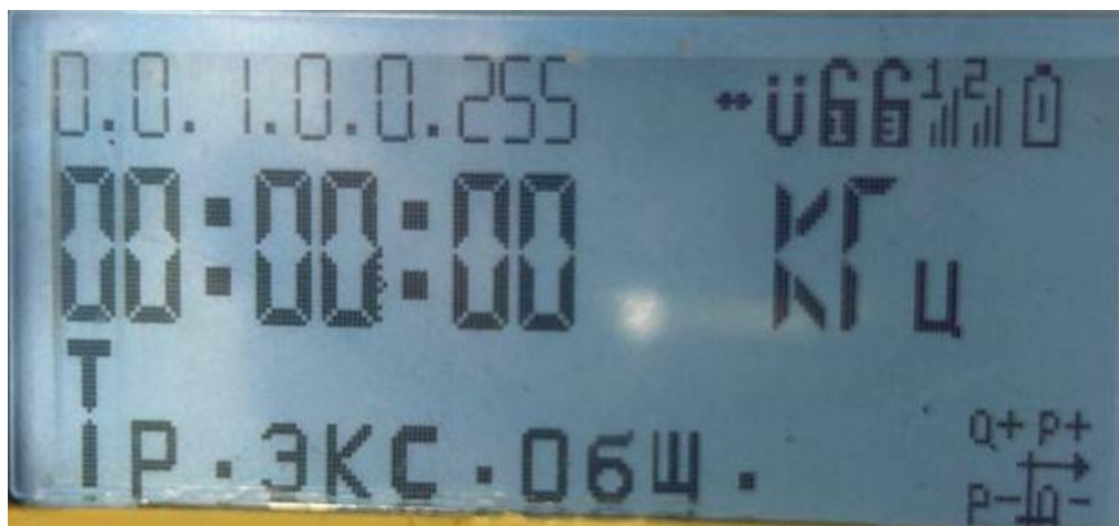
Рисунок Б.4 – Общий вид ЖКИ выносного цифрового дисплея НАРТИС-Д101В
