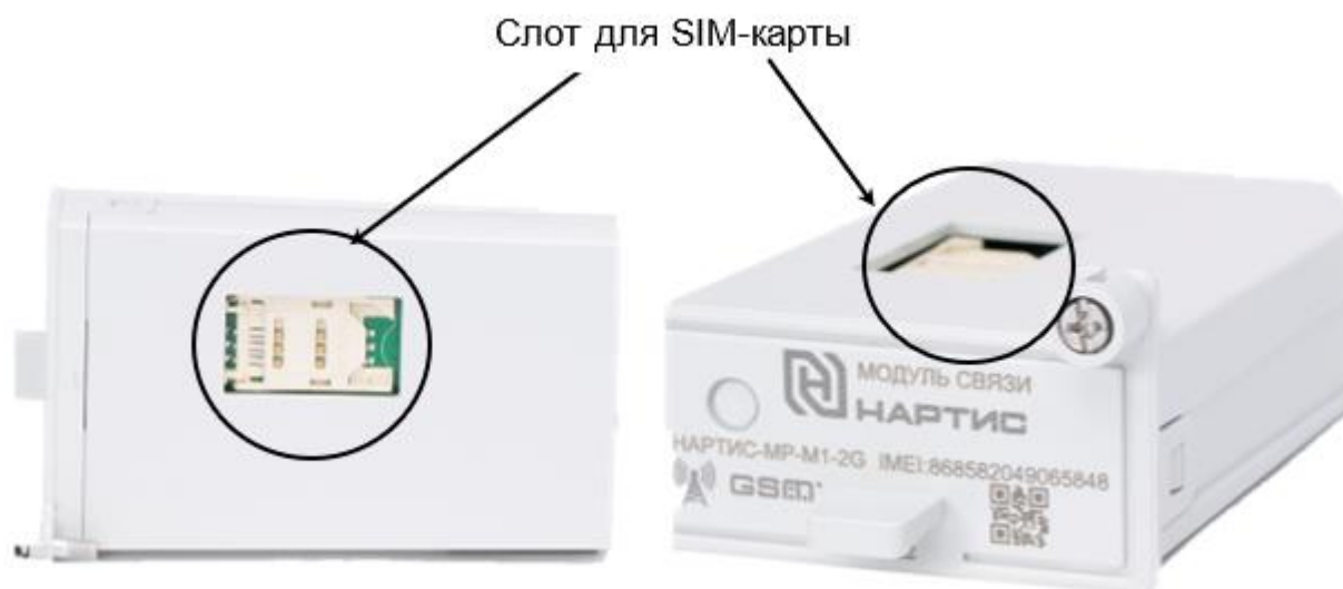
Рисунок Д.1 – Расположение слота SIM-карты в корпусе модуля связи НАРТИС-МР-M1
