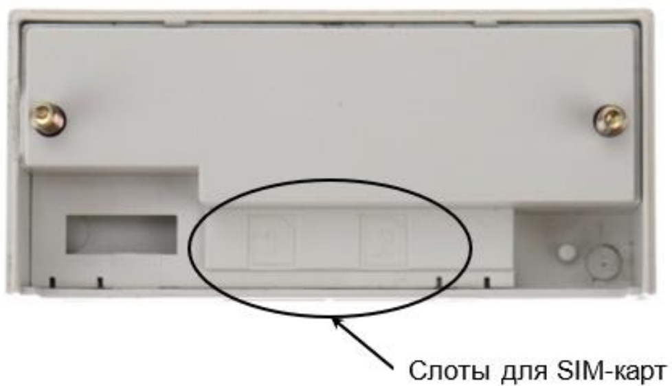
Рисунок Д.3 – Расположение слотов SIM-карт в корпусе модулей связи НАРТИС-МР-М3.3
