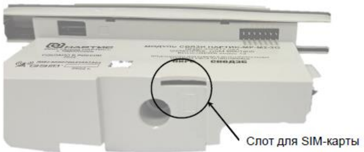
Рисунок Ж.2 – Расположение слота SIM-карты в корпусе модуля связи HARTIS-MP-M2.1
