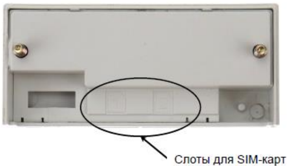
Рисунок Ж.3 – Расположение слотов SIM-карт в корпусе модуля связи НАРТИС-МР-М3.1
